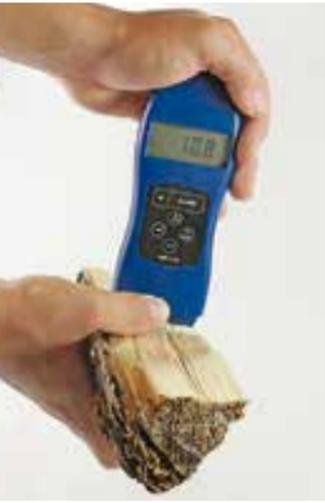
*Messung des Wassergehaltes mit einem Schnellbestimmungsgerät*
